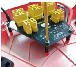
2. 安装分电板 加高 16mm
