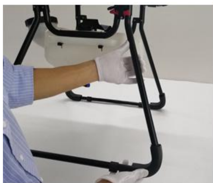
检查脚架安装情况，连接处是否已打安装螺丝孔
