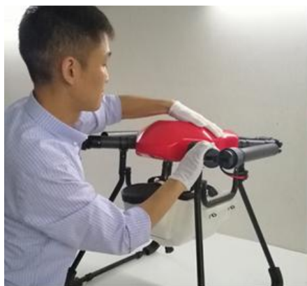
擦拭机身 检查外观、所有零件安装是否到位
