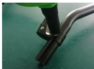
2.打孔安装大弯
