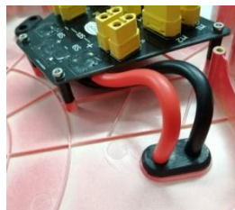
3. 分电板电源线出口
