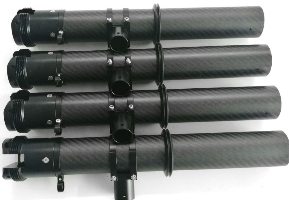
后臂总成安装完成（配件机臂总成样板）
