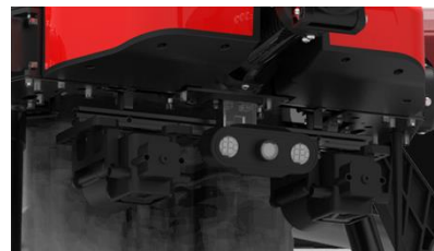
三体摄像实时监控作业画面
