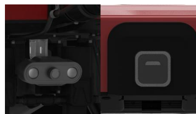
FPV 模块尾灯位安装
