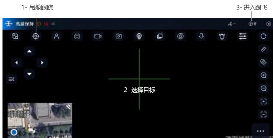
⚙️ 目标跟飞功能需要完成飞控与吊舱适配，功能使用时，请选择已经完成适配的吊舱品牌和型号。
